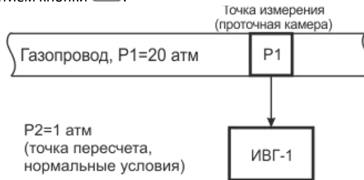
Рисунок 5.4 Пример использования техники пересчета
